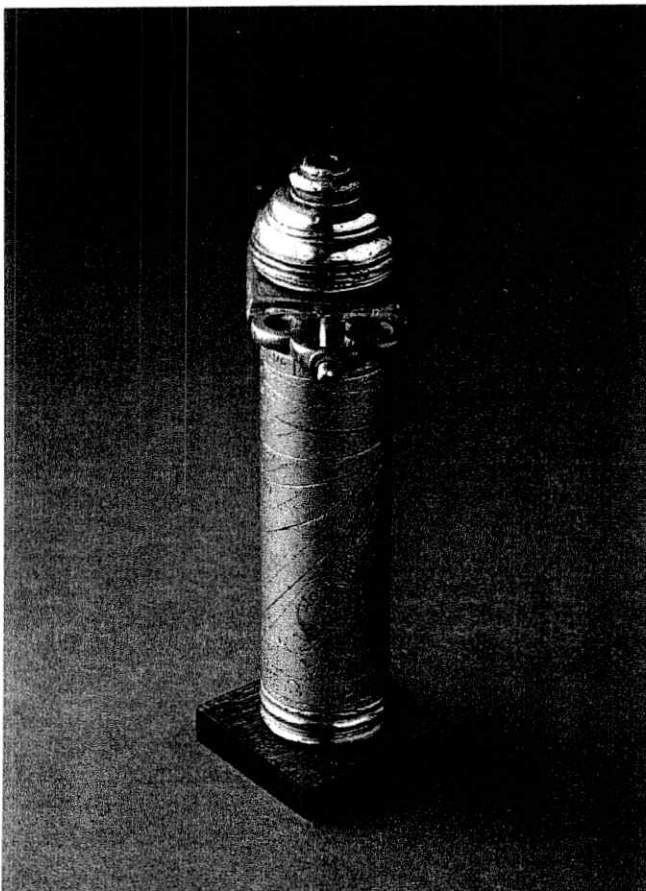
Voorbeeld van een draagbare cilindervormige zonnewijzer met een loodrecht op de cylindermantel staande schaduwwerper of gnomon (16de eeuw).
